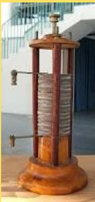
En 1799, Alessandro Volta, physicien italien, invente la pile électrique en empilant alternativement des disques de métaux différents séparés par des disques de feutre imbibés d'une solution salée.
